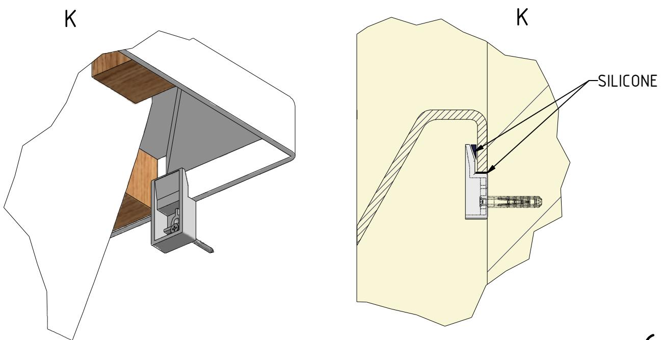
usazení s pomocí panelu \*
